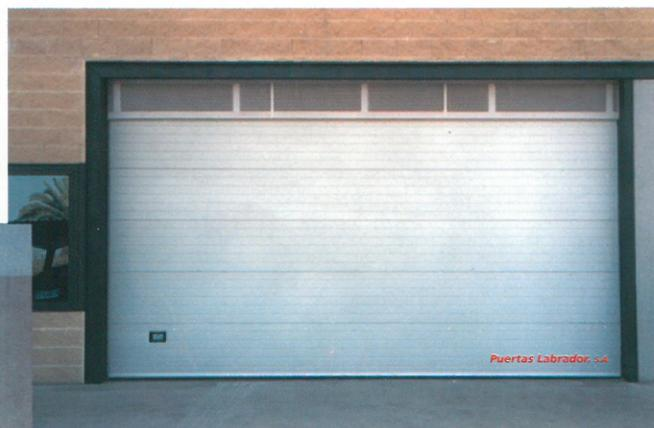
**L**as puertas seccionales de acero galvanizado acabado en esmalte con inyección de espuma de poliuretano acabado panel forma acanalizado son especiales para cierres, puntos de carga, naves industriales, garajes, ...
